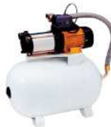
GB - GRUPO BOMBEO SIMPLE MONTADO CON CALDERIN MEMBRANA 50 LITROS, TE 5 VIAS, PRESOSTATO, MANOMETRO Y MANGUERA FLEXIBLE 1"
